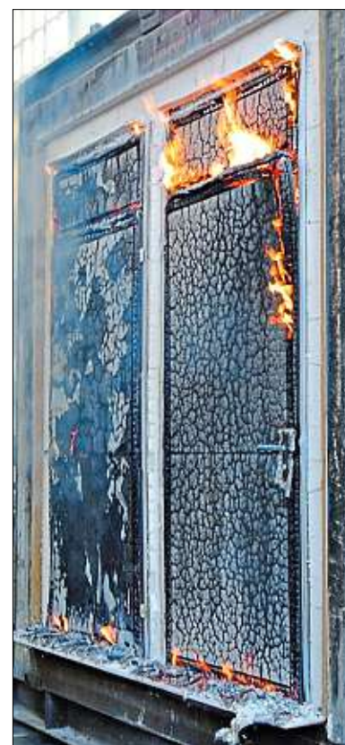
In aufwändigen Tests werden Brandschutztüren auf ihre Qualität getestet. – Foto: H-Flachs
