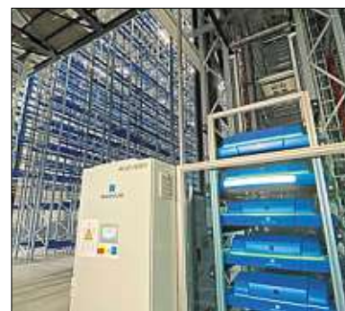
Das Kleinteilelager wird von vollautomatischen Robotern angefahren, die die Teile dann im gesamten Gebäude verteilen
